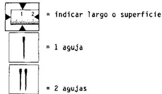
2.2 Para los ribeteadores hay que indicar el ancho de la cinta, para las garniciones de 2 agujas, la distancia entre agujas, y para los elementos de corte, la distancia de corte.
